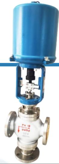
电动三通调节阀是采用双阀芯上下导向结构，和电动执行器组合而成。阀体为四通结构，即一进二出（分流型 F），二进一出（合流型 H），从而达到流体混合升温或降温作用，或液体不等量分流，满足不同工况的使用需求。该阀体具有结构紧凑，重量轻、动作灵敏，压降损失小、允许压新式高、阀容量大、流量特性精确和维护方便等优点，可用于各种不同的工作条件，特别适用于石油、工业交换器的温度控制系统和期货各行各业自动化控制。
